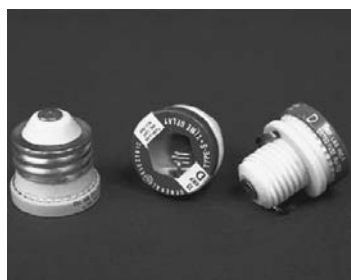
▲ FIGURA 18.20 Fusibles a) Un fusible contiene una tira o una cinta metálica que se funde cuando la corriente excede cierto valor establecido. Esto abre el circuito y evita el sobrecalentamiento. b) Los fusibles base de Edison (a la izquierda) tienen una rosca similar a la de las bombillas de luz. Las roscas son idénticas en este tipo de fusibles; así, es posible intercambiar fusibles con diferente clasificación de amperaje. Los fusibles tipo S (a la derecha) tienen roscas distintas para clasificaciones diferentes, por lo que no es posible intercambiarlos.
