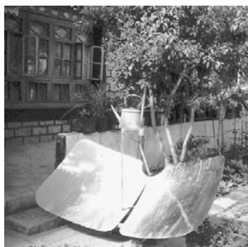
▲ FIGURA 11.13 Una aplicación práctica de la transferencia de calor por radiación Una tetera tibetana se calienta enfocando la luz solar con un reflector metálico.
