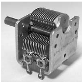
▲ FIGURA 21.14 Condensador variable de aire Al girar las placas móviles entre las placas fijas, se modifica el área de traslape y, por consiguiente, la capacitancia. Esos condensadores eran comunes en los circuitos de sintonización de los radios antiguos.
