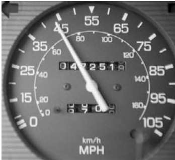
▲ FIGURA 2.2 Rapidez instantánea El velocímetro de un automóvil da la rapidez en un intervalo de tiempo muy corto, así que su lectura se aproxima a la rapidez instantánea.
