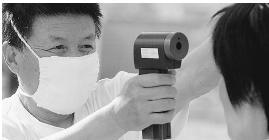
► FIGURA 11.14 Detección del SARS Durante el brote del síndrome respiratorio agudo severo (SARS) registrado en 2003, se utilizaron termómetros de rayos infrarrojos para medir la temperatura corporal.
