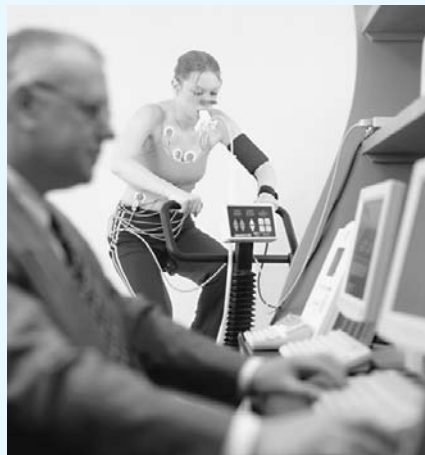
FIGURA 1 Medición de la energía consumida y el trabajo realizado Un dispositivo que registra la respiración y un dinamómetro permiten conocer tanto la potencia como la tasa metabólica de esta ciclista.
