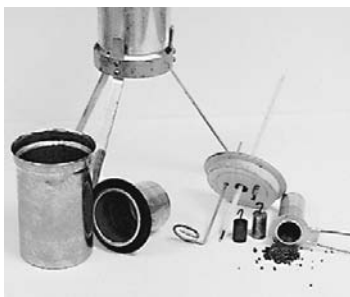
▲ FIGURA 11.4 Dispositivo de calorimetría El vaso para calorimetría (centro, con anillo negro aislante) entra en el recipiente grande. La tapa con el termómetro y el agitador aparecen a la derecha. Se calientan municiones o trozos de metal en el vaso pequeño (con mango), el cual se inserta en el agujero en la parte superior del generador de vapor que está en el trípode.
