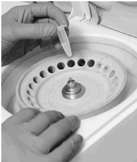
▲ FIGURA 7.10 Centrífuga Se usan centrifugas para separar partículas de diferente tamaño y densidad suspendidas en líquidos. Por ejemplo, en un tubo de centrifugación es posible separar los glóbulos rojos de los blancos y del plasma que constituye la porción líquida de la sangre.
