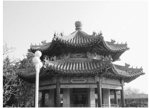
▲ FIGURA 11.19 Aspectos de diseño solar pasivo en la China antigua a) En verano, cuando el ángulo del Sol es grande, los aleros dan sombra a la construcción. Los ladrillos y las paredes de la casa son gruesos para reducir el flujo de calor por conducción al interior. En invierno, el ángulo del Sol es bajo, por lo que los rayos solares entran a la vivienda, en especial con la ayuda de los aleros curvos y ascendentes. Las hojas de los árboles caducifolios cercanos ofrecen sombra adicional en verano, pero permiten la entrada de luz solar cuando han perdido sus hojas en invierno. b) Imagen de una construcción como la descrita, en Beijing, China, en diciembre.
