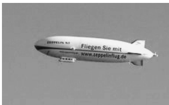
▲ FIGURA 9.12 Flotabilidad en fluidos El aire es un fluido en el que flotan objetos como este dirigible. El helio en su interior es menos denso que el aire circundante. La fuerza de flotabilidad resultante sostiene al dirigible.
