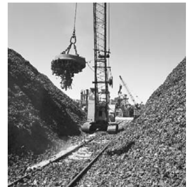
▲ FIGURA 19.28 Electroimán a) (arriba) Cuando no hay corriente en el circuito, no hay fuerza magnética. (abajo) Sin embargo, cuando pasa corriente por la bobina, hay un campo magnético y el núcleo de hierro se magnetiza. b) Detalle del extremo inferior del electroimán del inciso a . El pedazo de hierro es atraído hacia el extremo del electroimán. c) Un electroimán levantando chatarra
