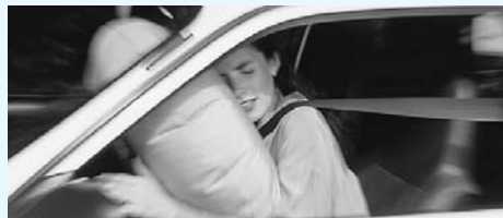
FIGURA 1 Impulso y seguridad La bolsa de aire de un automóvil prolonga el tiempo de contacto para detenerse y evita que el conductor se golpee contra el tablero o con el parabrisas en caso de un choque; al inflarse, la bolsa de aire disminuye la fuerza de impulso que podría causar lesiones.
