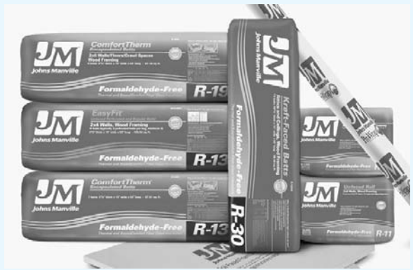
FIGURA 1 Diferencias de valor R Para mantas de aislante hechas con el mismo material, los valores R son proporcionales al espesor del material.
